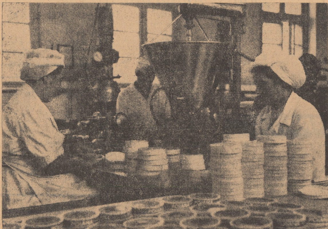
La mașina automată de umplut și ambalat brînzeturi topite de la I.C.I.L. „Sibiana”, se realizează o producție de 3.200 cutii a 6 triunghiuri în 8 ore.
