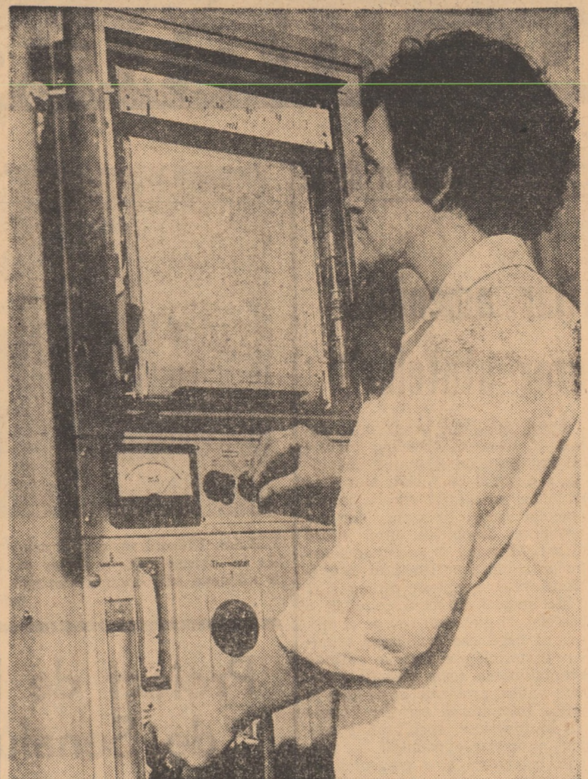
Instytutul „Chimigaz” Mediaș. Laboratoare moderne, utilate cu aparate de înaltă tehnicitate, stau astăzi la dispoziția cercetătorilor. Iată unul din aceste aparate — cromatograful de gaze, folosit la analiza amestecurilor de sinteze organice
