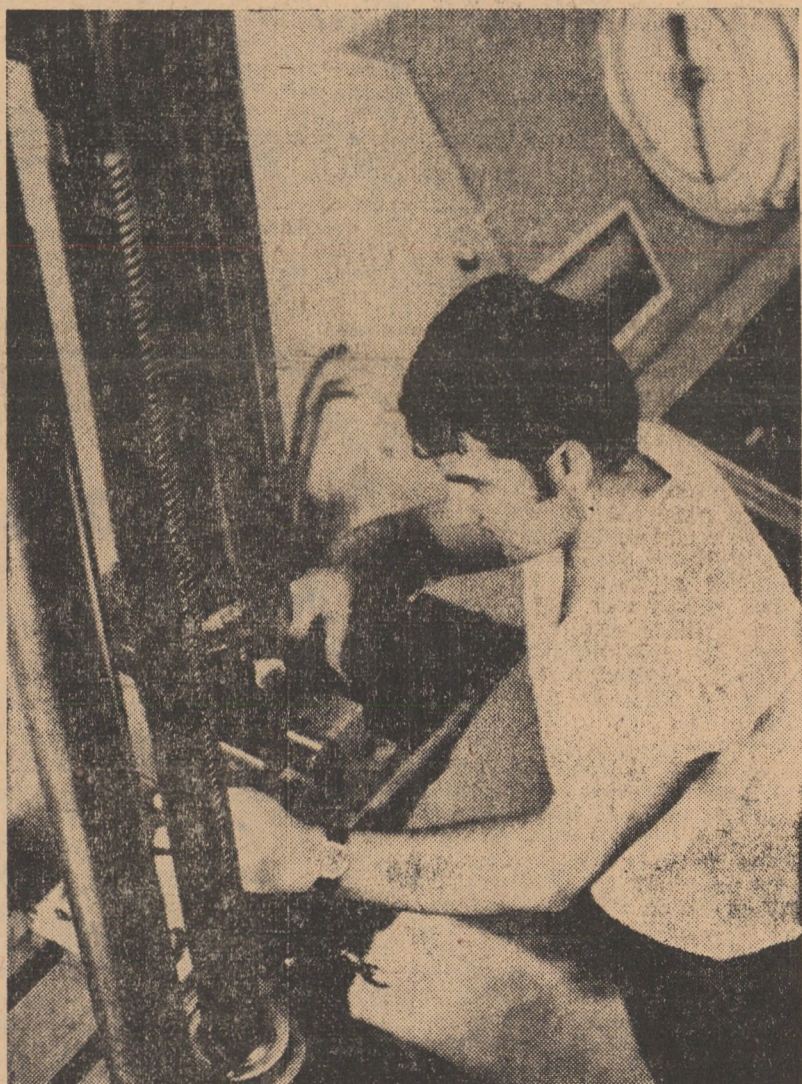
Uzina mecanică Mirșa. Încercarea materialelor și a sudurii la piesele asamblate se face în laborator cu ajutorul unor aparate speciale, asigurîndu-se astfel o calitate constantă a produselor realizate în uzină
