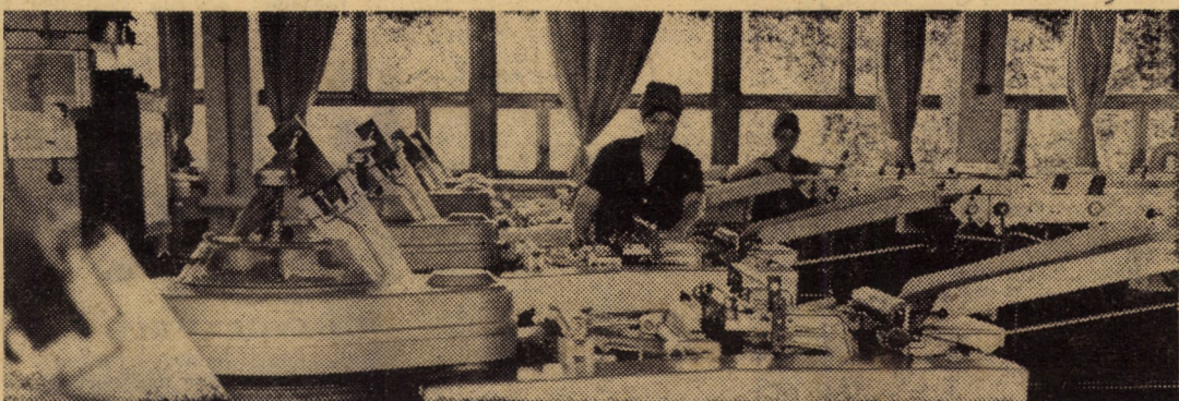
Imagine din moderna secție de prepararea filaturii cu laminoare de mare întindere de la fabrica „Libertatea” din Sibiu Foto: FRED NUSS
