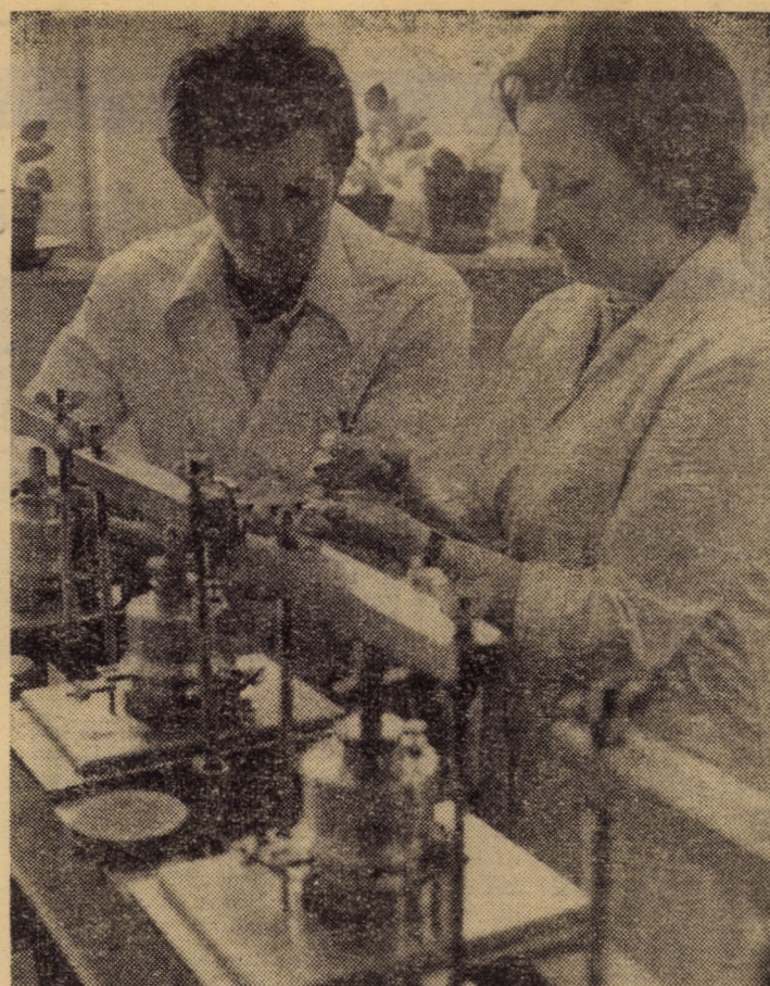
Filiala Sibiu a I.C.P.A.S. — În laboratorul de geotehnie sînt efectuate o serie de analize fizico-mecanice ale solului înaintea executării unor lucrări hidrotehnice Foto: FRED NUSS
