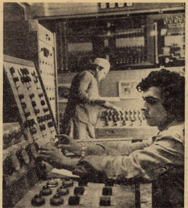
La pupitrul de comandă al dozatorului automat pentru macrocomponente de la întreprinderea pentru producerea nutrețurilor combinate Sibiu
