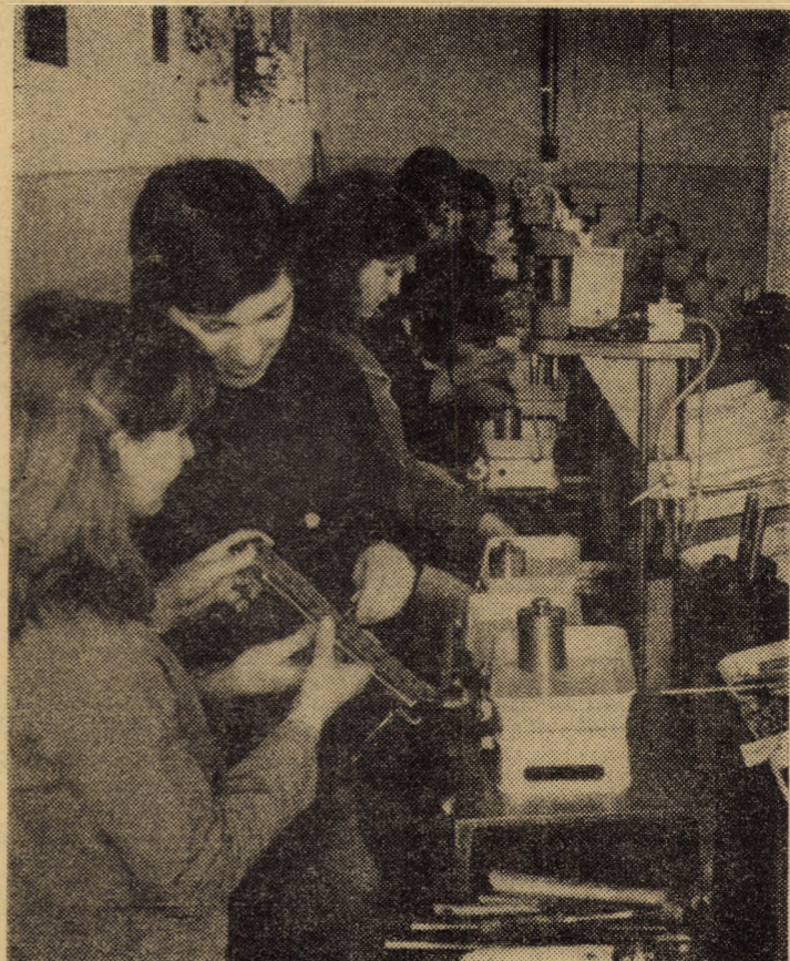
Printre multiplele acțiuni de reorganizare a fluxului tehnologic de la întreprinderea „Balanța” din Sibiu se înscrie și banda de montaj balanțe pentru gospodărie de 10 kg, realizate prin autoutilare. Mecanizarea fluxului de montaj permite, în prezent, asamblarea a peste 250 balanțe într-un singur schimb
