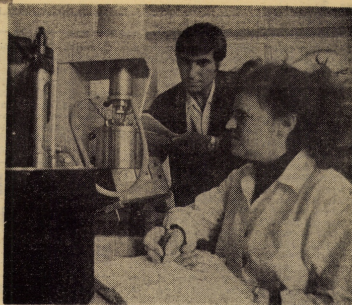
Verificarea uleiurilor folosite în procesul de producție cu ajutorul viscozimetruului în laboratorul central al întreprinderii „Flamura roșie” Sibiu. În fața aparatelor: laboranții Gabriela Fofeldea și Aurel Opriș
