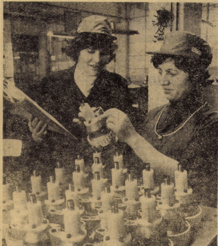
Tibori Estera și Veronica Suciu, muncitoare în atelierul confecției accesorii textile a secției metal II a întreprinderii „Flamura roșie” Sibiu, verificând un lot de amortizoare hidraulice pentru războaie de țesut care înlocuiesc cu succes piesele pînă acum importate Foto: FRED NUSS
