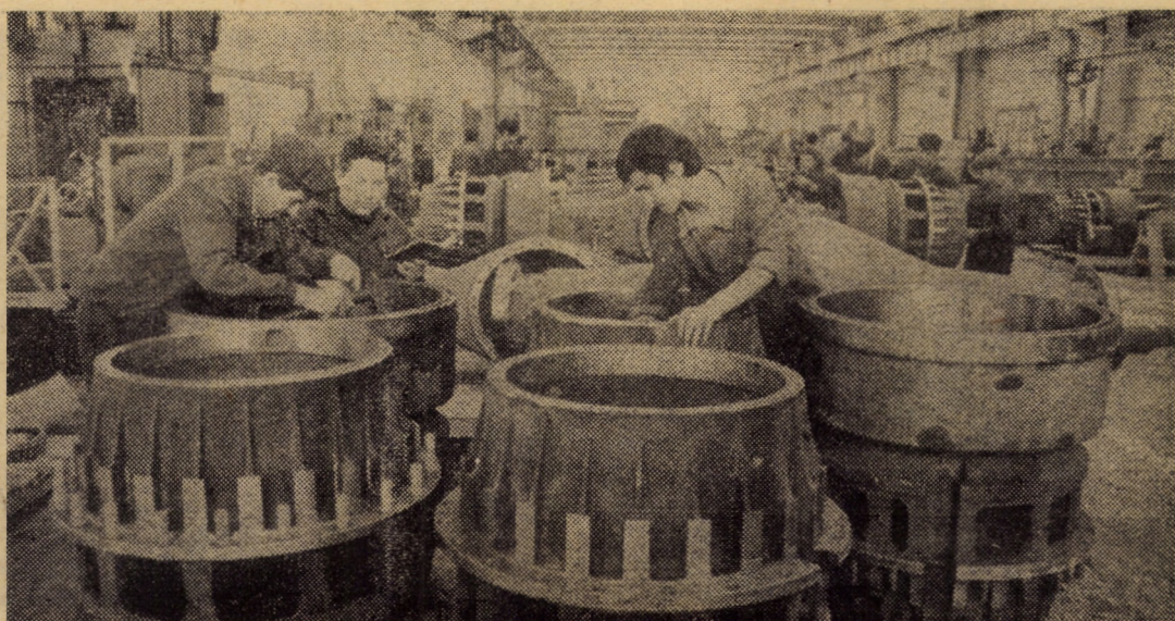
I.M. Mirza: secvență de lucru de pe linia de fabricație a punților motoare pentru autobasculantele de 50 t
