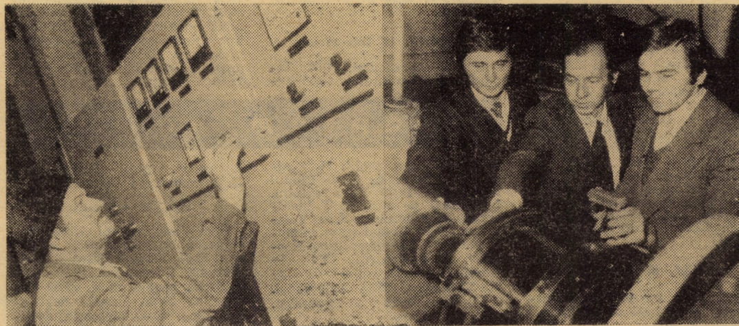
De cîțva timp, în hala de tratamente termice a întreprinderii „Mecanica“ Sibiu funcționează o instalație de călit axe prin curenți de medie frecvență. În stînga: panoul de comandă și reglaj al instalației deservit de maistrul Constantin Șoftelea. În dreapta: autorii noii instalații, inginerii proiectanți Mircea Dronca, Leonard Ilie și Alexandru Ilie Foto: FRED NUSS
