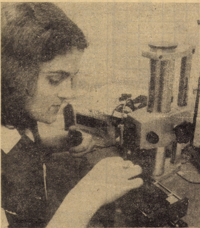
În laboratorul „unităților de lungimi” de la Institutul național de metrologie — filiala Sibiu — tehnician Petruța Vlasie efectuează etalonarea cadelor plan paralele cu ajutorul aparatului „Tessa modul”, avînd o precizie de 0,01 micrometri
