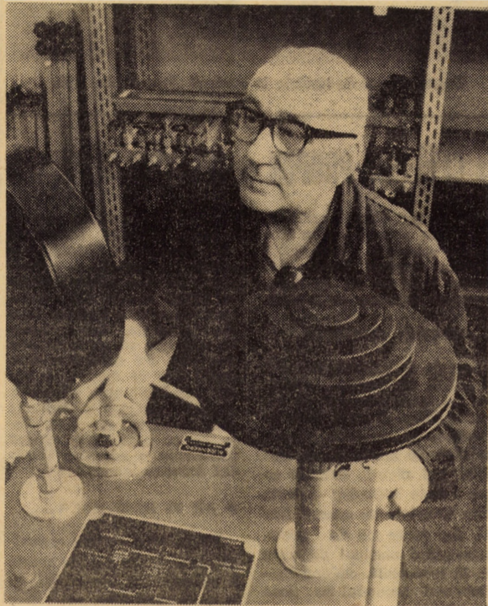
Cu o bogată experiență acumulată în decursul anilor, tehnicianul Ștefan Iavorsky de la Institutul național de metrologie, laboratorul presiuni precise - filiala Sibiu - etalonează manometre de înaltă precizie Foto: FRED NUSS
