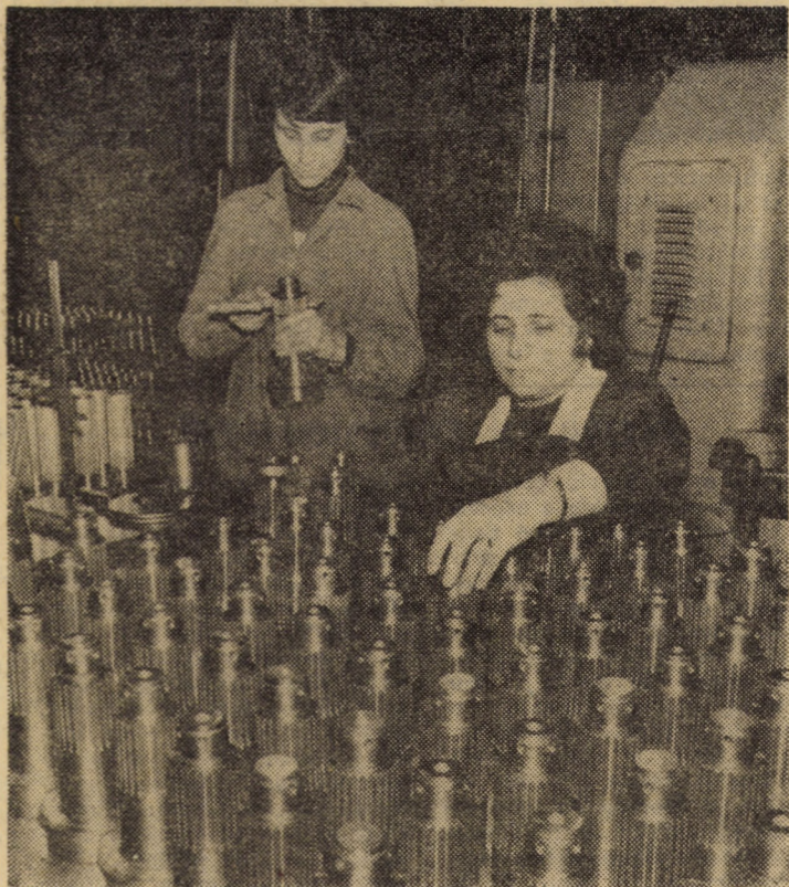
Controlul fusului axului cardanic în secția 300 a I.P.A. Sibiu înaintea montajului, o ultimă verificare efectuată de Maria Șerban și Elena Fleșu Foto: Fred NUSS
