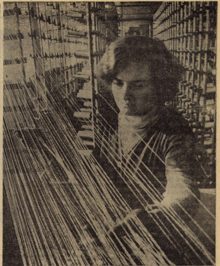
În imagine, muncitoarea Ana Grădinaru, efectuând o operațiune de mare dificultate, aducerea firelor de pe ramă prin spațiul la un urzitor de mare capacitate, din secția urzit, a întreprinderii „Drapelul roșu”, Sibiu Foto: Fred NUSS
