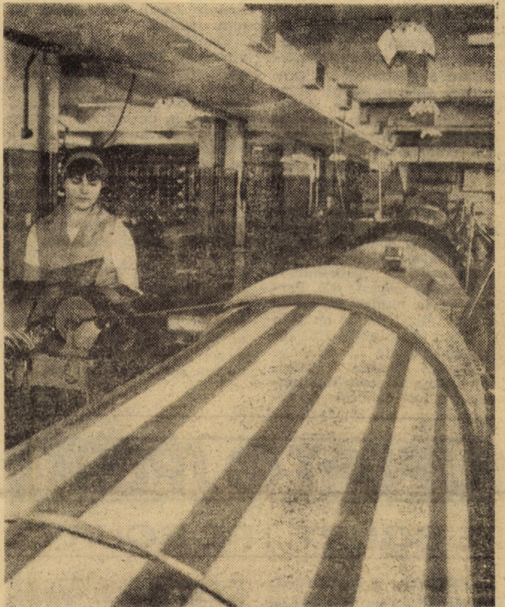
Întreprinderea „Drapelul roșu” Sibiu: imagine din secția unde se pregătește urzeala necesară mașinilor rapide de tricotat
